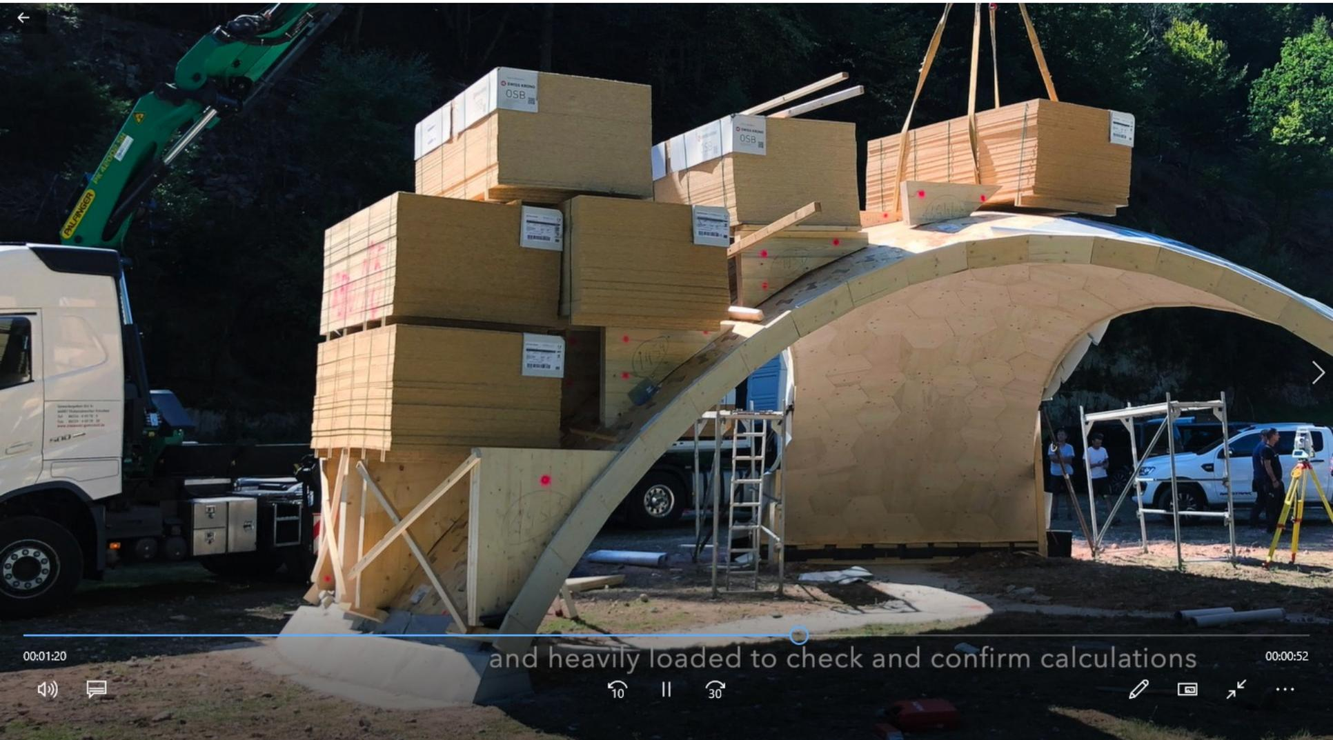
**Der Prüfstatiker ist beruhigt: beim Belastungstest bestätigen die gemessenen Verformungswerte die Ergebnisse der statischen Berechnung**
